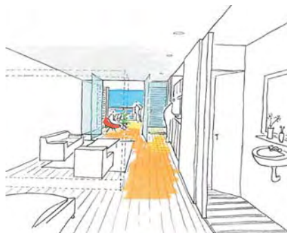
Espaços interiores flexíveis que garantem a ventilação cruzada natural | Espacios interiores flexibles que garantizan la ventilación cruzada natural
