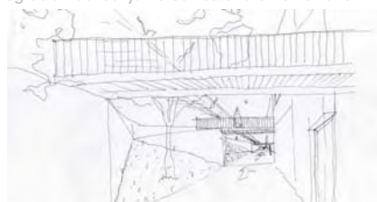
Ventilação no térreo através do jardim | Ventilación en pl. baja mediante patio inglés
